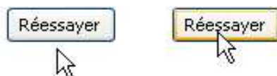
Figure 20 Exemple de changement d'état du bouton au passage de la souris et du focus (surbrillance de l'item sélectionné)
